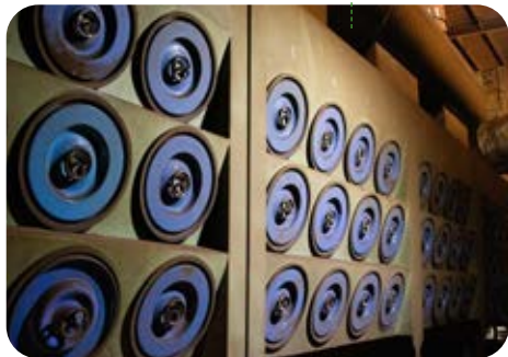
布袋收集装置与废气综合处理装置
